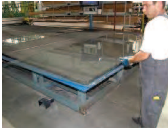
Rys. 3. Stanowisko do rozkroju szkła: a) automatyczne nacinanie szyb, b) ręczne łamanie
