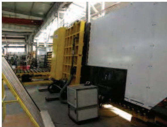
Rys. 6. Linia zespalania szyb: a) rolki transportowe przed myjką, b) prasa
