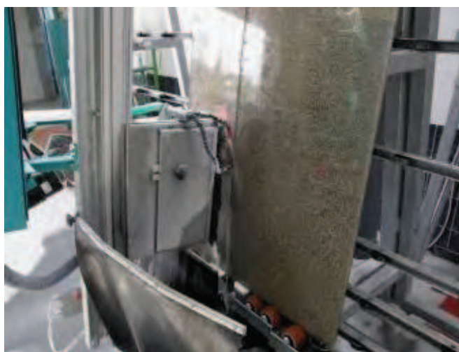
Rys. 4. Stanowisko do cięcia szkła laminowanego piłą diamentową
