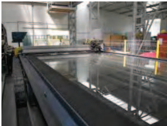
Rys. 3. Stanowisko do rozkroju szkła: a) automatyczne nacinanie szyb, b) ręczne łamanie
