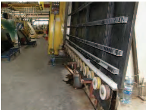
Rys. 6. Linia zespalania szyb: a) rolki transportowe przed myjką, b) prasa
